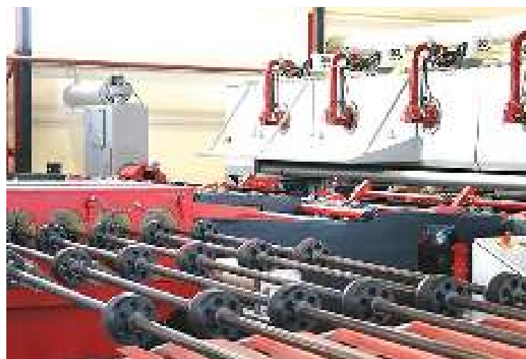
Новое европейское оборудование, производитель TKPS (TURN KEY PIPELINE SERVICES B.V.), в котором реализованы новые подходы к качеству и надежности наносимых полимерных покрытий на трубы нефтяного сортамента в диапазоне типоразмеров диаметром от 60 до 168 мм, длиной 8-12 м, максимальный вес трубы до 800 кг. Технологическая линия рассчитана на покрытие: НКТ диаметром от 60 до 114 мм, бурильных труб «СБТ» типоразмером диаметром до 140 мм, обсадных труб - до 168 мм.
