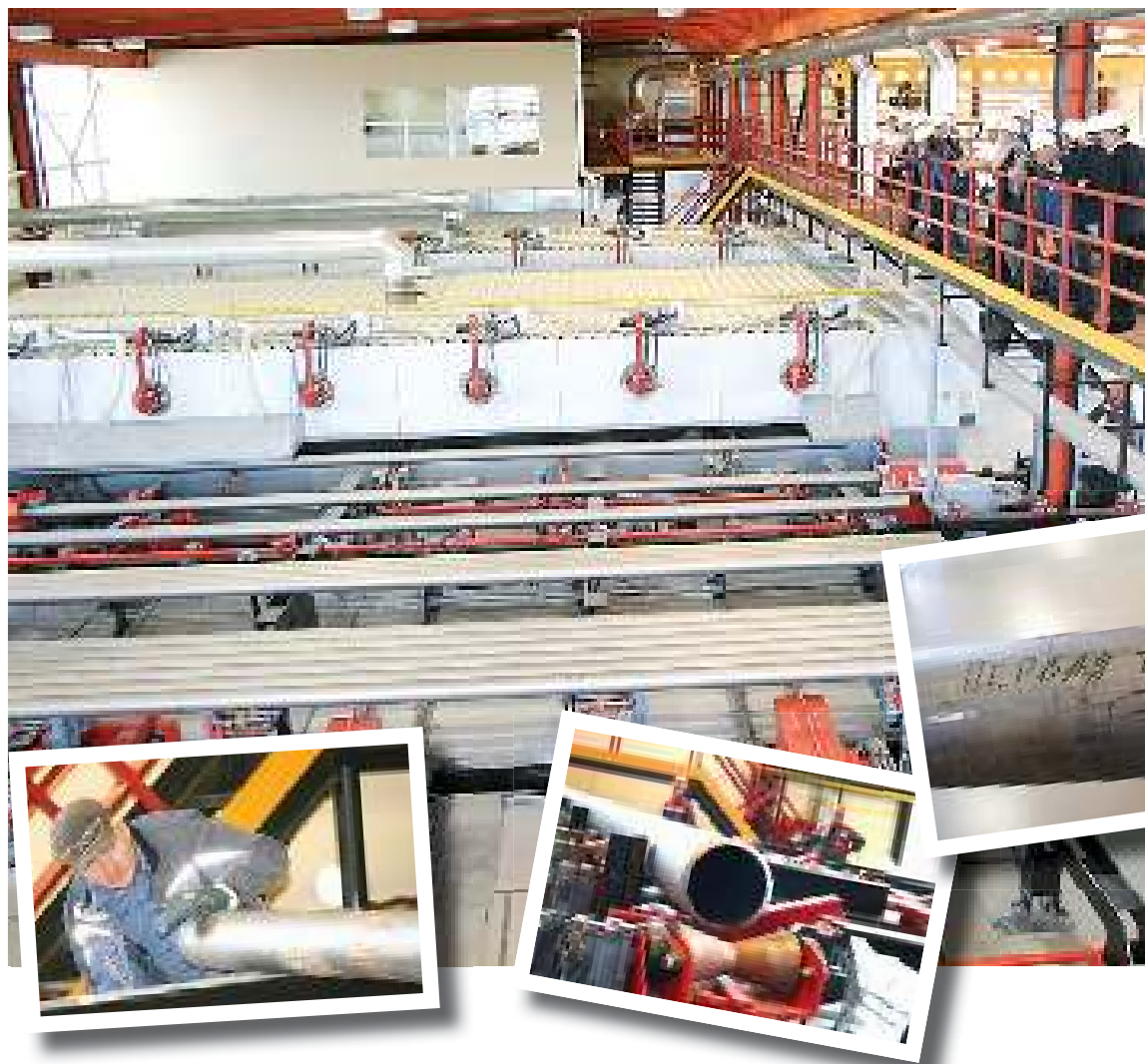
Новое европейское оборудование, производитель TKPS (TURN KEY PIPELINE SERVICES B.V.), в котором реализованы новые подходы к качеству и надежности наносимых полимерных покрытий на трубы нефтяного сортамента в диапазоне типоразмеров диаметром от 60 до 168 мм, длиной 8-12 м, максимальный вес трубы до 800 кг. Технологическая линия рассчитана на покрытие: НКТ диаметром от 60 до 114 мм, бурильных труб «СБТ» типоразмером диаметром до 140 мм, обсадных труб - до 168 мм.
